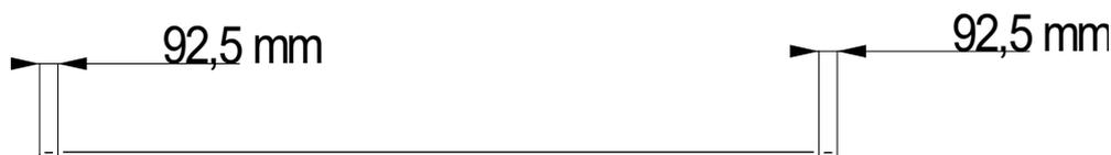
Fig. 45 : Le profilé d'isolation est plus court que le rail conducteur.
